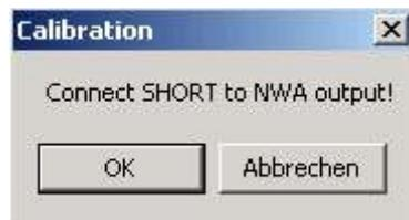
Ahora, conecte los estándares de calibración, que le pide, y pulse Aceptar cuando haya terminado. Output es sinónimo de puerto TX e input puerto RX . Si pulsa "Cancelar", no se llevará a cabo la medición. Puede repetir cualquier medición de calibración en cualquier momento. Puede calibrar en el orden que desee. Después de una calibración adecuada, la luz roja correspondiente se vuelve verde que indica que los datos de calibración válidos está disponibles:
