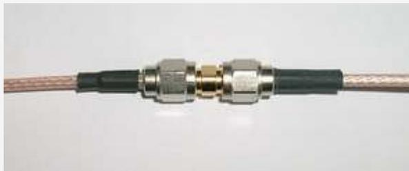
Tenga en cuenta que el adaptador introduce algún cambio de fase debido a su longitud eléctrica que ha de tenerse en cuenta en la calibración para medidas de reflexión más precisas.
