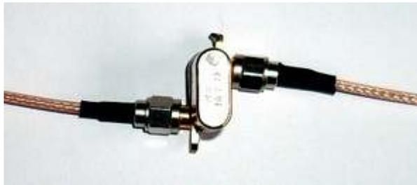
Los únicos efectos restantes a corregir, es que su plano de referencia, aún se encuentra en el extremo del adaptador Thru , ahora estaría bien muy cerca de su objeto a prueba y en caso de una calibración de dos puertos, su adaptador Thru para el paso de “ Thru cal” debería haber sido el doble pero en realidad los efectos pueden ser compensados al activar el menú "Measure"- "Port Extensions":
